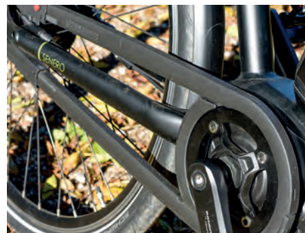
Die Kette ist komplett geschlossen: Hosenseiten verkleben? Unmöglich.
