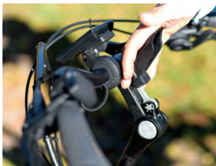
Vorbau: Kein Werkzeug zum Verstellen nötig, ein zupackender Griff reicht.
