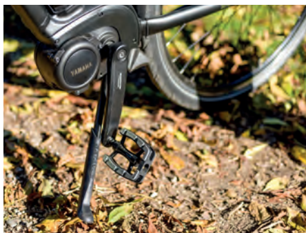
Yamaha-Power im Mittelmotor PW-S. Pfiff: Der Ständer klappt auch nach vorn.
